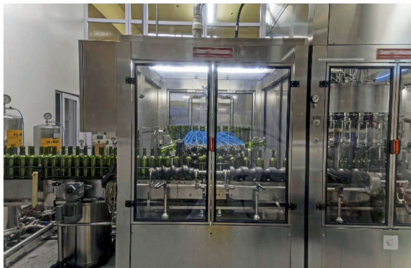
Maquinário de indústria vinícola para envasamento de garrafas de vinho no município de Bento Gonçalves, no estado do Rio Grande do Sul. Fotografia de 2024.
