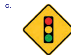
Placa de Semáforo à frente.
