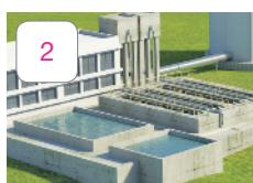
A água passa por um processo de filtração, que elimina pequenas partículas de impurezas.
