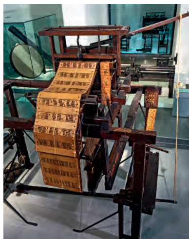
Tear mecânico de Jacquard, com destaque para os cartões perfurados.
