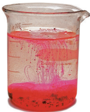
Figura 10. Cinzas adicionadas à água contendo fenolftaleína. A solução é avermelhada, evidenciando meio básico. Cinzas reagem com água, formando KOH e, em menor quantidade, NaOH. Cinzas têm caráter básico e NÃO devem entrar em contato com pele e olhos.
