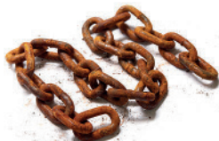
Figura 15. Essa corrente de ferro, exposta a ambiente úmido, ficou recoberta de ferrugem.
