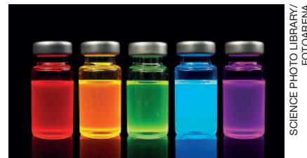
Figura 6. Dispersões aquosas de pontos quânticos de seleneto de cádmio (CdSe) com diferentes tamanhos, desde 5 nm (no frasco à esquerda) até 0,7 nm (no frasco à direita).
