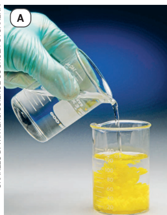
Figura 6. Precipitação de \text{PbI}_2 fotografada quando se adicionou solução aquosa de \text{Pb}(\text{NO}_3)_2 à solução aquosa de \text{KI} . O precipitado pode ser separado da solução por filtração (B).
