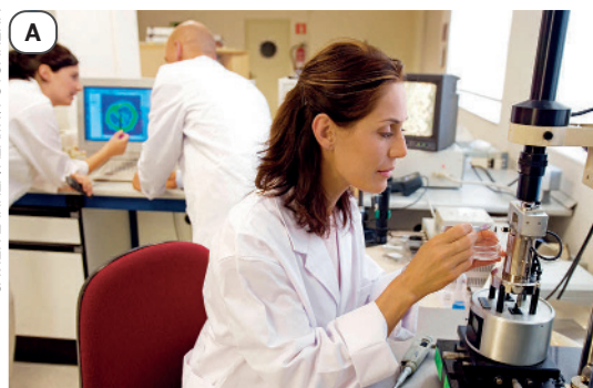
Figura 11. (A) Pesquisadora de nanotecnologia inserindo amostra em microscópio de força atômica para realizar nanocaracterização. (B) Visão frontal do equipamento. (Centro de Física de Materiais, Espanha.)
