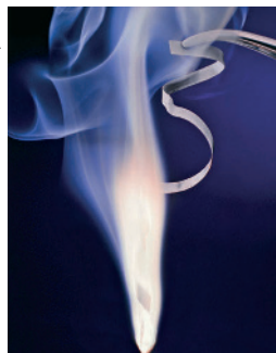
Figura 5. A combustão de magnésio, que forma óxido de magnésio (MgO), é uma reação exotérmica. (Esse experimento NÃO deve ser realizado pelos estudantes, pois a luz emitida é muito intensa e pode ofuscar e danificar a visão.)
