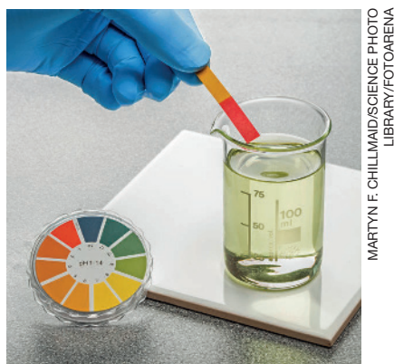
Figura 11. A ponta do papel indicador universal é mergulhada na solução e comparada com uma escala colorida.
