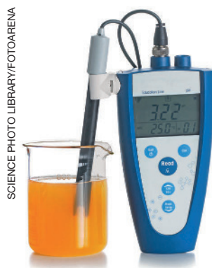
Figura 12. Medidor digital de pH . O sensor está na extremidade da haste mergulhada na solução. Na foto, mede-se o pH de suco de laranja, a 25 °C, resultando em 3,22.
