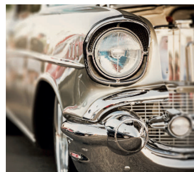
Figura 9. Detalhes metálicos cromados em peças de automóveis são obtidos por eletrodeposição de cromo metálico, técnica que é um exemplo de galvanoplastia.
