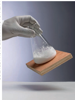
Figura 7. O erlenmeyer foi colocado sobre um pedaço úmido de madeira. Dentro do frasco, a ocorrência da reação entre hidróxido de bário e cloreto de amônio, endotérmica, acarretou recebimento de calor das vizinhanças, solidificando a água abaixo do erlenmeyer e aderindo a madeira ao vidro. (Esse experimento NÃO deve ser realizado pelos estudantes devido à toxicidade dos íons bário.)
