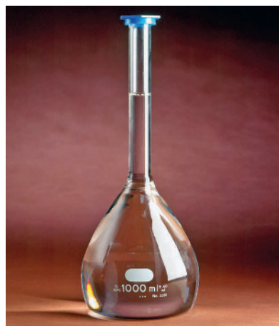
Figura 6. Solução aquosa preparada utilizando 50 g do soluto cloreto de sódio (NaCl) dissolvido em quantidade suficiente do solvente água para obter 1,0 L de solução.
