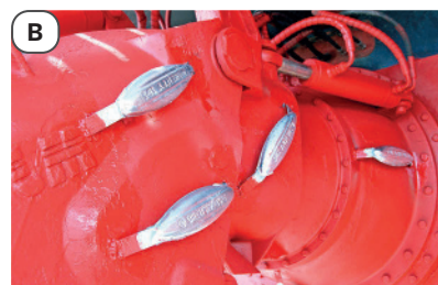
Figura 16. (A) Embarcação suspensa para reparos. (B) Foto da região próxima a um dos propulsores, em que são visíveis ânodos de sacrifício (de cor cinza metálica) soldados à estrutura de aço (pintada de vermelho). (Porto de Alicante, Espanha, 2017.)
