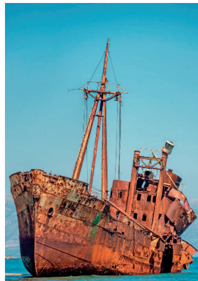
Figura 15. Restos de um navio abandonado, em 1980, próximo da Grécia. Ao longo de décadas, o ferro do navio reagiu com água e gás oxigênio, produzindo ferrugem, cuja coloração se deve a \text{Fe(OH)}_3\text{(s)} . (Praia de Selinitsa, banhada pelo Mar Mediterrâneo, Grécia, 2019.)
