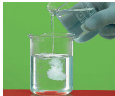
Figura 5. Precipitação de \text{AgCl} observada ao adicionar uma solução aquosa de \text{AgNO}_3 a uma solução aquosa de \text{NaCl} . Se, após a reação, o sistema for deixado em repouso, os cristais tendem a se depositar no fundo do recipiente.
