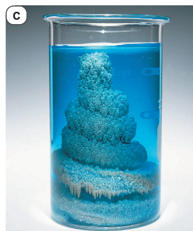
Figura 14. (A) Béquer com um fio de cobre metálico. Quando uma solução aquosa incolor de nitrato de prata é acrescentada a esse recipiente (B), ocorre a reação química de oxirredução comentada no texto (C).
