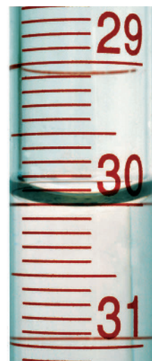
Figura 13. O volume da solução ácida que foi entregue pela bureta pode ser lido, ao final da titulação, na escala da bureta. No exemplo da foto, o volume foi 30 mL. Essa leitura é feita respeitando o que está indicado na Figura 10.
