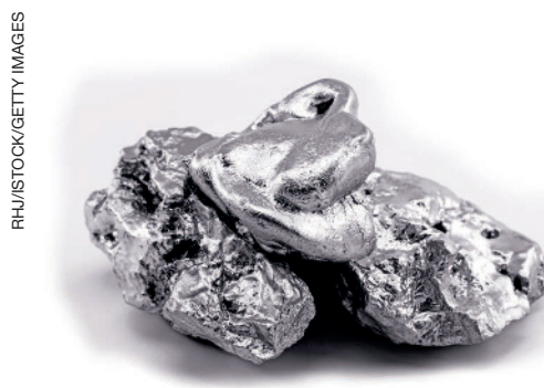
Figura 13. Amostra de níquel metálico ( d = 9,0 \text{ g/cm}^3 a 25 °C) com 26 mm de comprimento.
