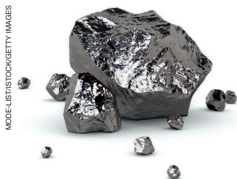
Figura 12. Amostras de titânio metálico ( d = 4,5 \text{ g/cm}^3 a 25 °C) de diferentes tamanhos. O comprimento da amostra maior é 17 mm.
