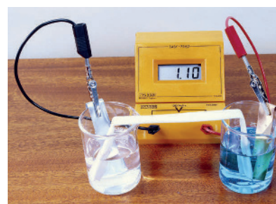
Figura 13. Medida da força eletromotriz de uma pilha de Daniell nas condições-padrão, a 25 °C. A resistência elétrica do voltímetro usado é muito alta se comparada à resistência interna da pilha, o que permite considerá-lo como um voltímetro ideal nesse experimento.
